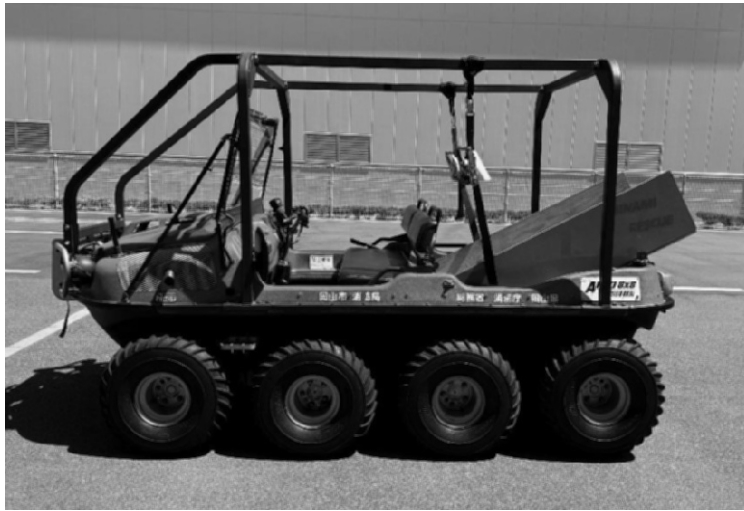
(写真7) ホース延長BOX積載状況
