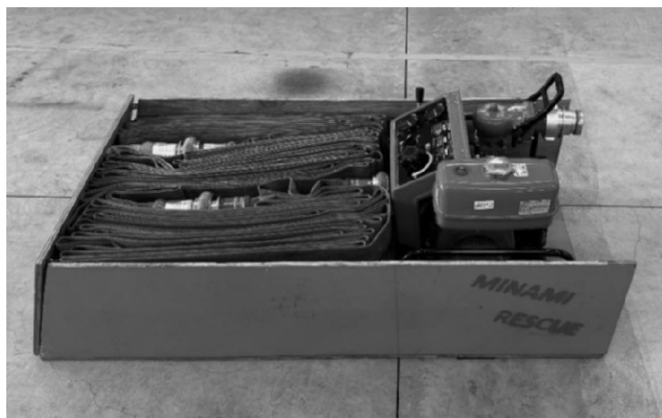
(写真9) 絡車ホース及び可搬ポンプ積載
